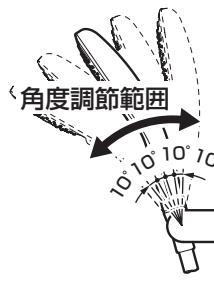
シャワーハンガーにシャワーへッドを確実にセットして角度を変える。
