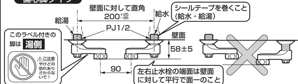
※寒冷地用の場合は取付脚の水抜コックが本体よりも上になると、水抜きができませんので必ず下になるように取り付けてください。
