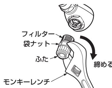
2. モンキーレンチを使用して袋ナットをゆるめてフィルターを取り外す。
