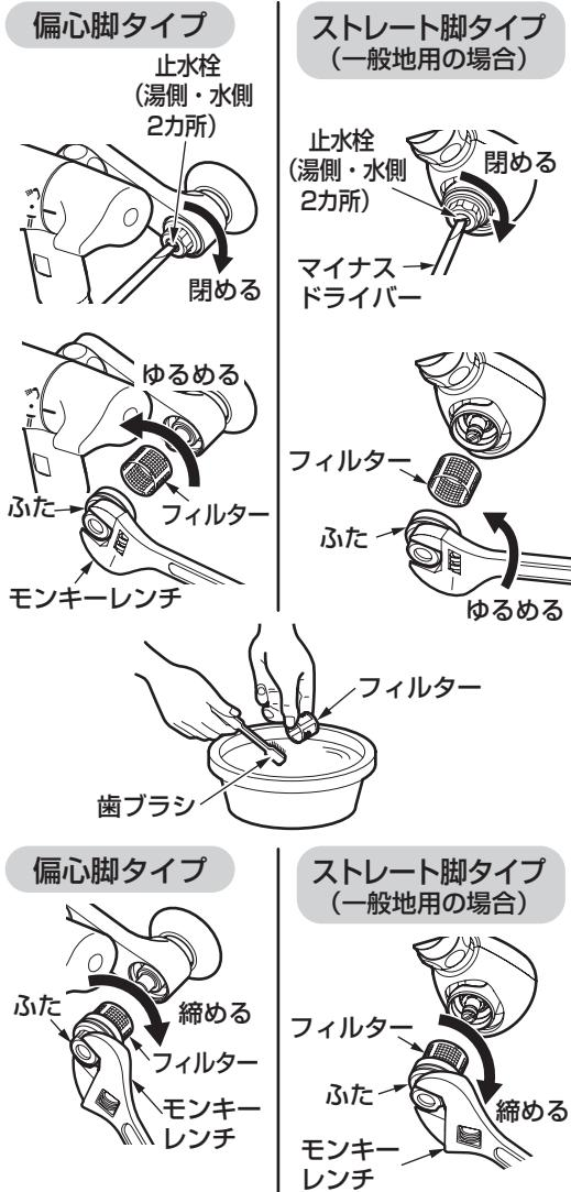
1. 開閉工具またはマイナスドライバーなどで湯側・水側の止水栓を閉める。
