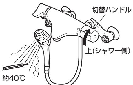
1. 給湯機の設定温度は希望の吐水温度より高めに設定する。
