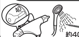
万一、凍結した場合は、温度調節ハンドルの目盛り "40" と吐水温度が設定しているか確認してください。凍結すると、設定温度がずれてやけどをするおそれがあります。
