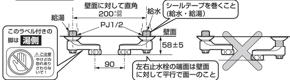
※寒冷地用の場合は取付脚の水抜コックが本体よりも上になると、水抜きができませんので必ず下になるように取り付けてください。
