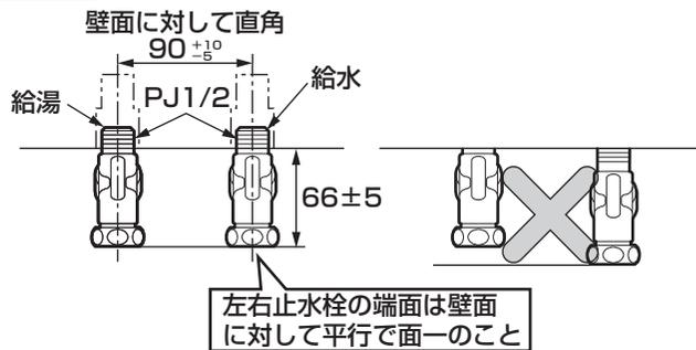
※寒冷地の場合は止水栓の取付位置が本体よりも上になると、水抜きができませんので必ず下になるように取り付けてください。また、止水栓を内側に施工した場合、流量調節やフィルターのメンテナンスが困難となります。
