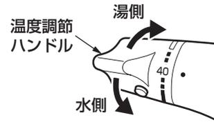
2. 流量が15L/分程度(洗面器一杯にするのに約15秒弱)になるように水側止水栓で調節する。
