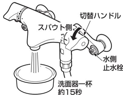
3. 安全ボタンを押しながら、温度調節ハンドルを上(湯側)いっぱい回し、2.と同じように湯側止水栓で流量を調節する。
