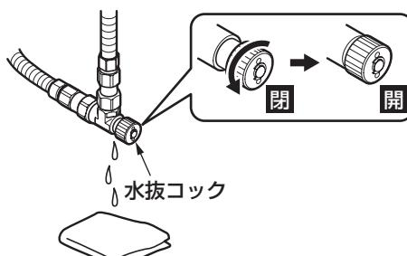
3. 水抜コックの下に台拭きなどを用意し、水抜コックを開ける。
