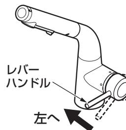
6. 水が抜けたら、レバーハンドル・水抜コックを閉める。
