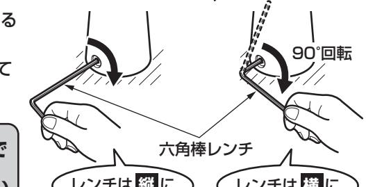
⑤六角棒レンチの横方向で、約90°回して確実に締め付ける。
