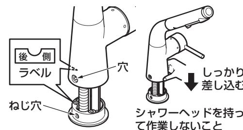
③ねじが斜めにならないよう水栓本体固定ねじは必ず仮止め工具で仮固定する。
