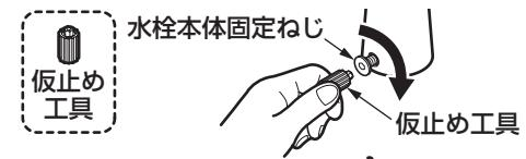
④六角棒レンチの縦方向で、回らなくなるまで締め付ける。
