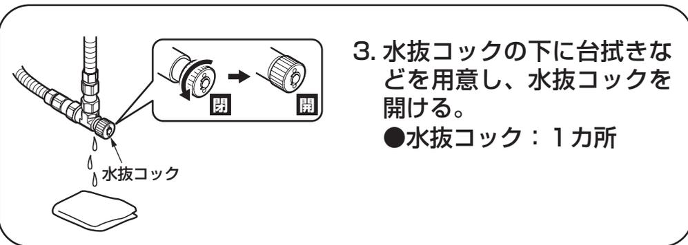
3. 水抜コックの下に台拭きなどを用意し、水抜コックを開ける。
