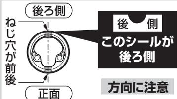
③ 引き上げ部材を引き上げたまま、ボルト・座金（2本）を固定金具に通し、手締めで4～5回転ねじ込む。
