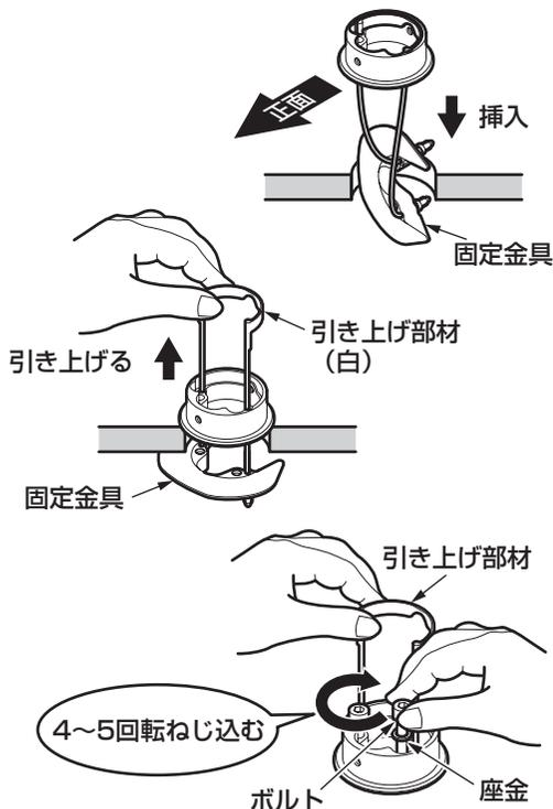
④ 引き上げ部材・ボルト・座金（2本）を押し下げ、上面施工用アダプターを**ボルトの方向に当たるまで**ずらす。
