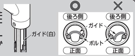
③ねじが斜めにならないよう水栓本体固定ねじは必ず仮止め工具で仮固定する。
