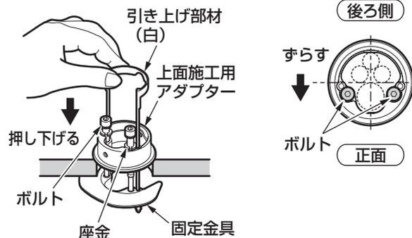
⑤ ボルトに六角棒レンチを縦に差し込み、**2本のボルトを交互に**強く締め付ける。
