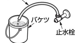
市販のフレキホースなどとバケツを準備し、止水栓に市販のフレキホースなどを接続して、ゆっくりと止水栓を開け、給水・給湯管内のごみ、砂などを洗い流してください。
