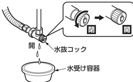
3. 水抜きコックの下に水受け容器（洗面器など）を用意し、水抜きコックを開ける。
