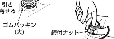
⑥最後にモーターレンチなどの工具を使用して確実に締め込む。
