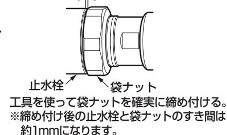
工具を使って袋ナットを確実に締め付ける。※締め付け後の止水栓と袋ナットのすき間は約1mmになります。
