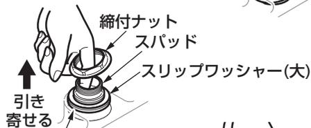
⑤あらかじめ指に締付ナットを通し、スパッドを取付穴の中心で引き寄せ、締付ナットを手で締め込む。
