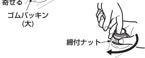
⑥最後にモーターレンチなどの工具を使用して確実に締め込む。
