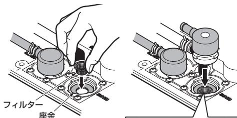
上図のように、座金の上にフィルターが正しい向きでセットされているのを確認してください。
