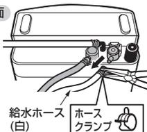
**2** 給水継手（白色ラベル）を吐水継手（灰）側まで回して、上に引き抜いて外し、新しい給水継手に付けかえる。
