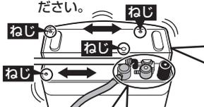
底板が左右に若干動き、継手を外しやすくなります。
