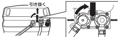
継手が外れにくい場合は、底板のねじをゆるめてください。
