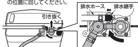
継手が外れにくい場合は、底板のねじをゆるめてください。
