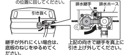
継手が外れにくい場合は、底板のねじをゆるめてください。
