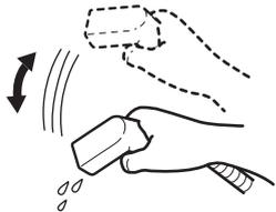
7. 水が抜けたら、スパウトを元に戻し、レバーハンドルを下げ、水抜コック・キャップを閉める。
