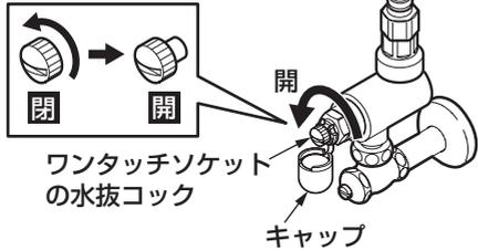
4. ワンタッチソケットの水抜コックのキャップを外し、水抜コックを反時計回りに止まるまで回す。
