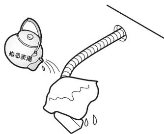
水抜きを行っても吐水口の網目やフィルターに付着した水滴が凍り、通水後も少しの間、水が出ない場合があります。そのときはスパウトを引き出し、タオルなどの布を巻き付け、しみこませるようにゆっくりとぬるま湯をかけてください。
