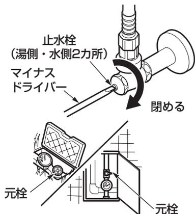
マイナスドライバーなどで湯側・水側の止水栓を閉める。
