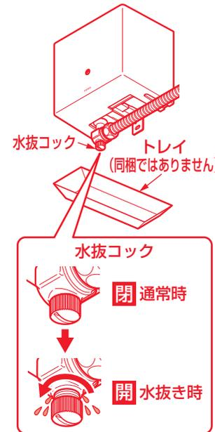
水抜コックの下にトレイを設置し、水抜コックを開ける。
