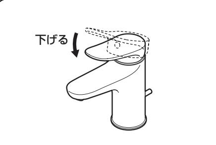
3. 水抜き完了後は、必ずレバーハンドルを下へいっぱいに下げる。(水が出ない状態)
