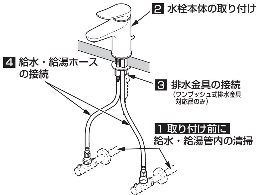
**1 取り付け前に 給水・給湯管内の清掃**
