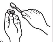
吐水口の取り外し、取り付けには同梱の開閉工具を使用してください。
