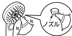
ノズルが詰まると流線が乱れる場合があります。水またはぬるま湯に浸した布をよく絞ってノズルを傷つけないように、軽く汚れをふき取ってください。強い力でふいたり、こすった場合、ノズルが破損したり、変形してさらに流線が乱れるおそれがありますのでご注意ください。
