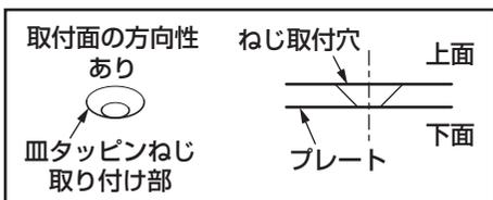
②-2 プレート (THK52) の上下を確認し、下側から通水本体部を差し込む。プレート (THK52) に付属の調整用ナット(大)を通水本体部にねじ込み、**A寸法**位置にナット上面をあわせる。
