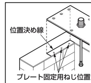
(1) ブロック上面の印を付けたフレーム固定用ねじ位置に下穴をφ6mmのドリルであける。
