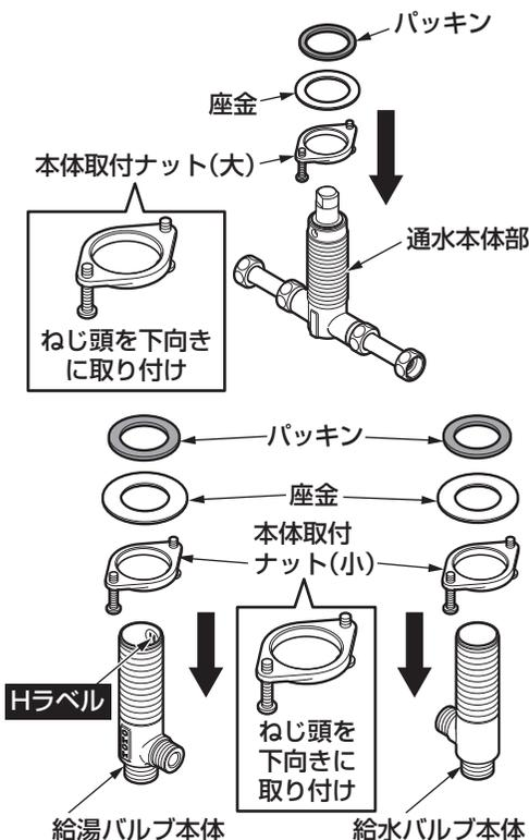
※タイル施工後に通水本体とバルブ本体の取付金具を締め付けるためタイル厚みを考慮し、調整用ナットで本体部の高さ調整 **A寸法** を行っておく。
