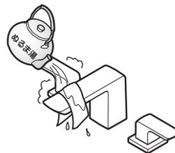
水抜きを行っても吐水口の網目に付着した水滴が凍り、通水後も少しの間、水が出ない場合があります。
