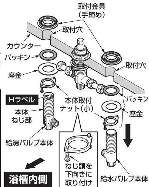
③ 連結管を締め付け、通水本体部とバルブ本体を接続する。
