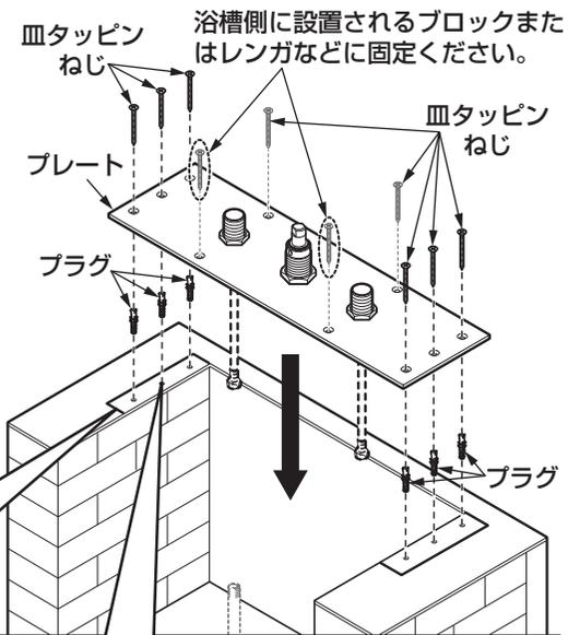
② 皿タッピンねじでプレートを固定する。
