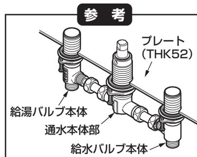
①-2 給水・給湯バルブ本体に本体取付ナット(小)・座金・パッキンの順に取り付けておく。
