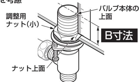
③ 連結管を締め付け、通水本体部とバルブ本体を接続する。
