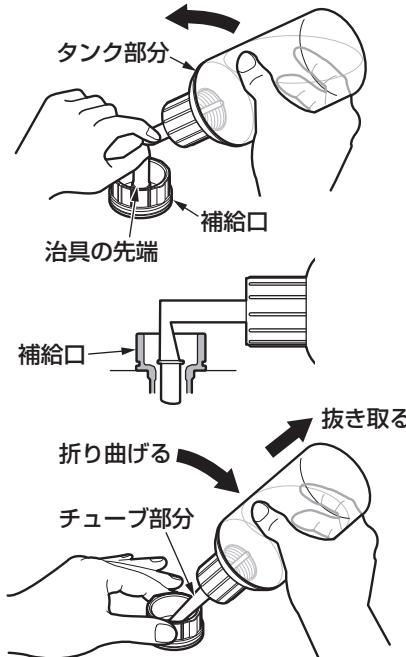
③ 治具の先端を補給口にしっかりと差し込み、抜けないように片手で押さえながら、治具のタンク部分を持ち上げる。
