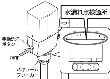
1. バキュームブレーカーの周囲を確認して、水漏れ跡がないかを確認する。
