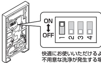
快適にお使いいただけるように、工場出荷時に150mmに設定しています。不用意な洗浄が発生する場合は、120mmに切り替えてください。
