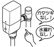
新築・改修工事後や水道断水復旧後は、必ず配管内の空気を抜く
