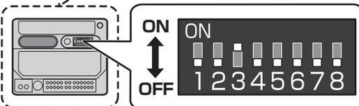
※コントローラ右側のゴムキャップを外して調節してください。
