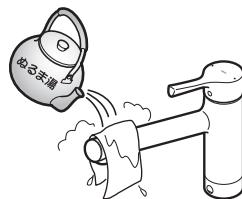
水抜きを行っても吐水口の網目に付着した水滴が凍り、通水後も少しの間、水が出ない場合があります。
