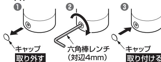
キャップまたは化粧キャップを外し、六角棒レンチ(対辺4mmおよび2.5mm)を使用してねじを締めなおす。
