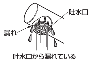
吐水口から漏れている
