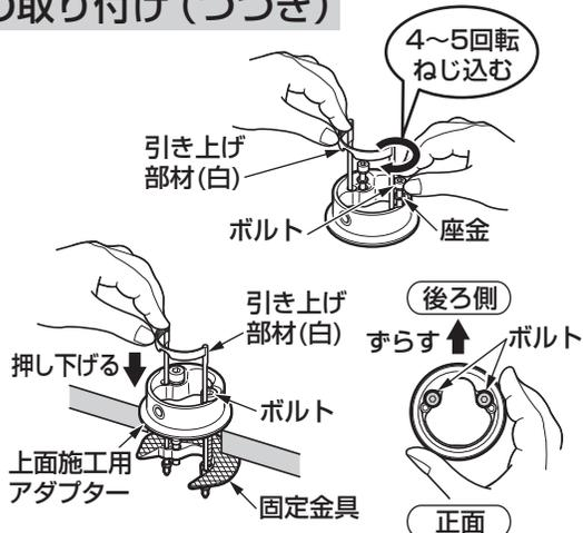
⑤ボルトに六角棒レンチを縦に差し込み、**2本のボルトを交互に**強く締め付ける。
