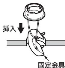
②上面施工用アダプターの方向をあわせ、固定金具が当たるまで引き上げ部材 (白) を引き上げる。
