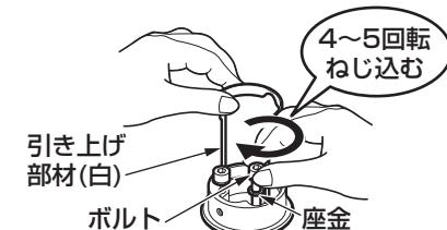
④引き上げ部材(白)・ボルト・座金(2本)を押し下げ、上面施工用アダプターをボルトの方向に当たるまでずらす。
