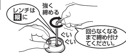
⑥さらに六角棒レンチを横にして2本のボルトを交互にしっかり締め付け、確実に固定する。
