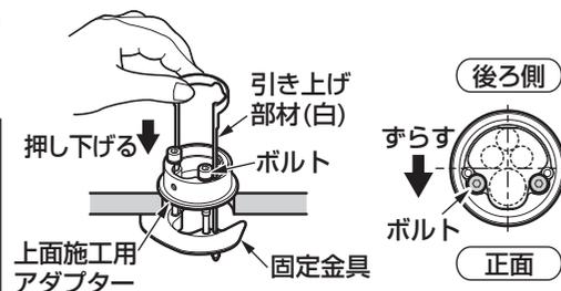
⑤ボルトに六角棒レンチを縦に差し込み、2本のボルトを交互に強く締め付ける。
