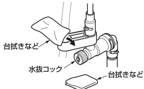
③ 台拭きなどを2枚用意し、1枚を水抜コックにかぶせもう1枚を水抜コックの下にしく。
