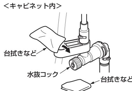
③ 台拭きなどを2枚用意し、1枚を水抜コックにかぶせもう1枚を水抜コックの下にしく。
