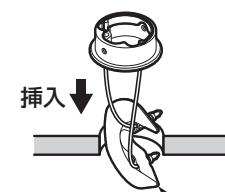
②上面施工用アダプターの方向をあわせ、固定金具が当たるまで引き上げ部材(白)を引き上げる。
