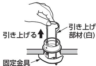
③引き上げ部材 (白) を引き上げたまま、ボルト・座金 (2本) を固定金具に通し、手締めで4~5回転ねじ込む。
