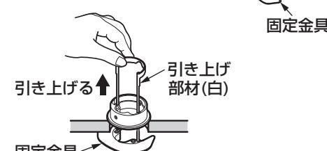
③引き上げ部材(白)を引き上げたまま、ボルト・座金(2本)を固定金具に通し、手締めで4~5回転ねじ込む。
