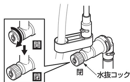
⑦ 水が抜けたら、レバーハンドル・水抜コックを閉める。(水抜き完了)
