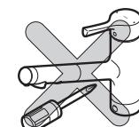
**必ず実行****フィルターの掃除をする際は、レバーハンドルを閉めてから、止め輪を外す**
