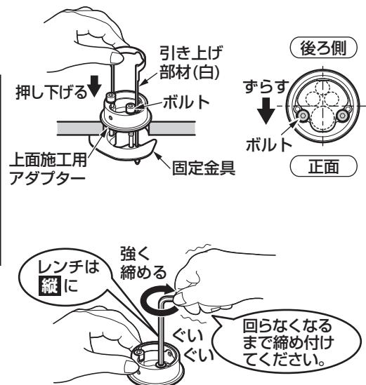
⑥さらに六角棒レンチを横にして2本のボルトを交互にしっかりと締め付け、確実に固定する。
