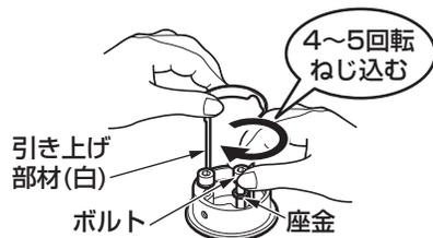
④引き上げ部材 (白) ・ボルト・座金 (2本) を押し下げ、上面施工用アダプターをボルトの方向に当たるまでずらす。
