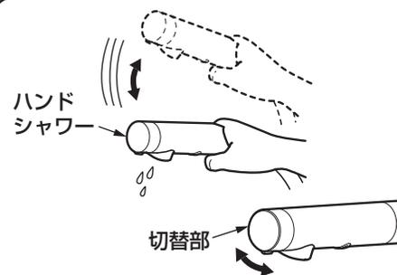
⑥ ホース内の水を抜く。切替部を数回切り替えながらホース内の水を抜く。
