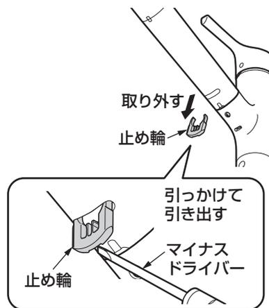
③ スパウトを抜き、継手とスパウトの間に入ったフィルターを取り外す。
