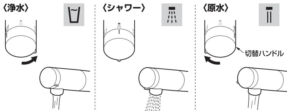
切替部を回して、切替部上部の「**II**」マークを「**V**」にあわせると、浄水が出ます。「浄水」は、**2**のみを流してご使用ください。
