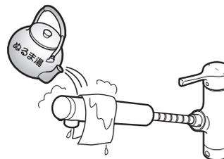
水抜きを行っても散水板の網目やフィルターに付着した水滴が凍り、通水後も少しの間、水が出ない場合があります。そのときは、ハンドシャワーを引き出し、タオルなどの布を巻き付け、しみこませるようにゆっくりとぬるま湯をかけてください。
