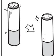
**浄水カートリッジ取り替え後は、約1分間「浄水」を流してから使用する**
