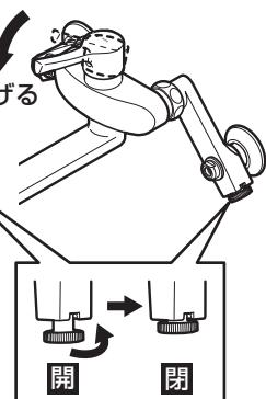
④ 水抜き完了後は、水抜コックを閉め、必ずレバーハンドルを下げる。**重要**
