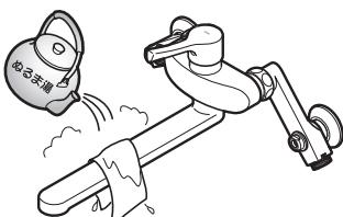
水抜きを行っても吐水口の網目に付着した水滴が凍り、通水後も少しの間、水が出ない場合があります。
