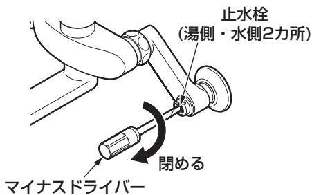
マイナスドライバーを差し込み、湯側・水側の止水栓を閉める。
