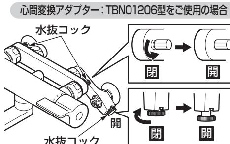
「心間変換アダプター」は、既設の脚を残して、TOTOサーモスタット混合水栓TBV034型に交換する場合に使用するアダプターです。
