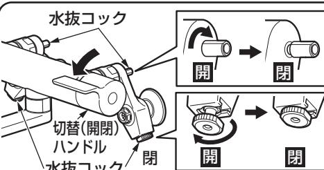
⑦ 水抜コック・切替(開閉)ハンドルを閉める。(水抜き完了)
