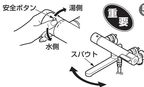
⑤ 安全ボタンを押したまま、温度調節ハンドルを湯側・水側と複数回切り替え、スパウトから水を抜く。
