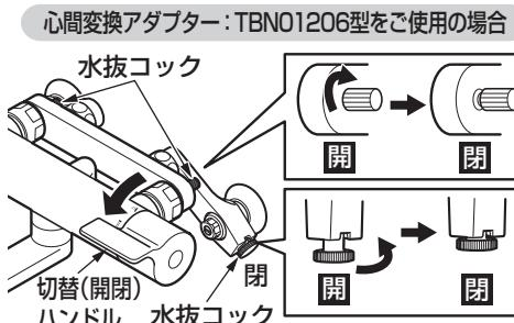
●取付脚部の水抜コック：2力所
