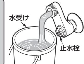
バケツなど水受けとなるものを準備し、壁や床に水が飛び散らないよう止水栓をゆっくり開き、給水・給湯管内のごみ、砂などを洗い流す。
