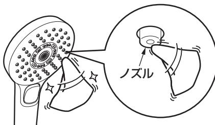
ノズルが詰まると流線が乱れる場合があります。水またはぬるま湯に浸した布をよく絞ってノズルを傷つけないように、軽く汚れをふき取ってください。強い力でふいたり、こすった場合、ノズルが破損したり、変形してさらに流線が乱れるおそれがありますのでご注意ください。
