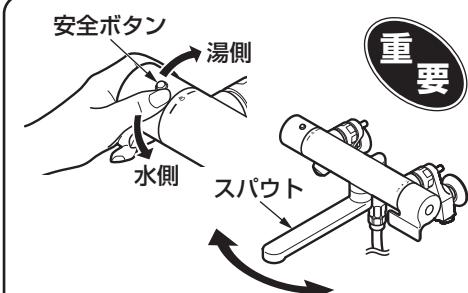
⑤ 安全ボタンを押したまま、温度調節ハンドルを湯側・水側と複数回切り替え、スパウトから水を抜く。
