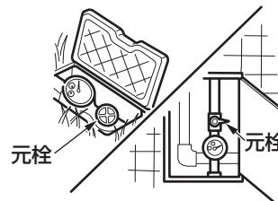
マイナスドライバーを差し込み、止水栓を閉める。
