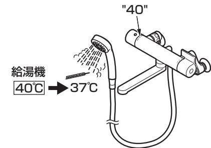
温度調節ハンドルは工場で設定していますが使用条件（給水・給湯圧力、給水・給湯温度）により、表示どおりの吐水温度にならないことがあります。以下の要領で確かめてください。
