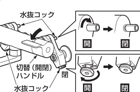
⑧ 水抜コック・切替(開閉)ハンドルを閉める。(水抜き完了)
