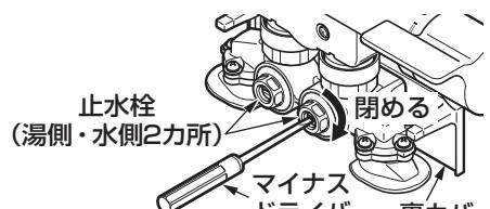
マイナスドライバーを差し込み、止水栓を閉める。
