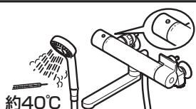
万一、凍結した場合は、温度調節ハンドルの目盛り"40"と吐水温度が設定されているか確認してください。凍結すると、設定温度がずれてやけどをするおそれがあります。
