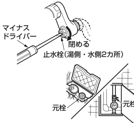
マイナスドライバーを差し込み、止水栓を閉める。
