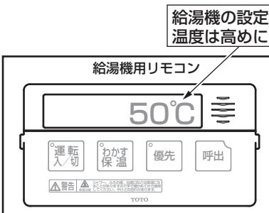
給湯機の設定温度は希望の吐水温度より高めに設定する。
