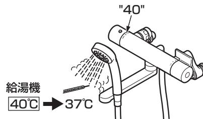
温度調節ハンドルは工場で設定していますが、使用条件（給水・給湯圧力、給水・給湯温度）により、表示どおりの吐水温度にならないことがあります。以下の要領で確かめてください。
