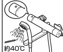
シャワー部フィルターの掃除をする際は、必ず水栓本体の開閉ハンドルを止水位置にあわせてから行う
