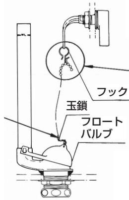
玉鎖はずれないように確実に取り付けてください。
