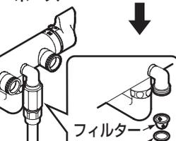
取付完了後、2~3回操作して水漏れがないことを確認してください。
