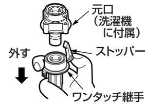
1. ワンタッチ継手のストッパーの根元を押さえながらワンタッチ継手を引き下げて元口を外す。
