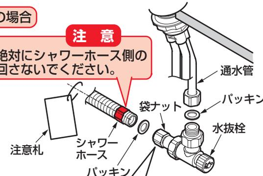
シャワーホース接続時は、水抜栓側の袋ナットを回して、シャワーホースを接続してください。
