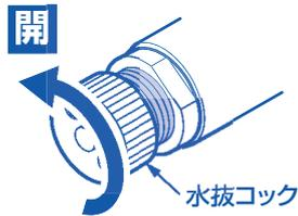
水抜きコックを反時計回りに止まるまで回す。
