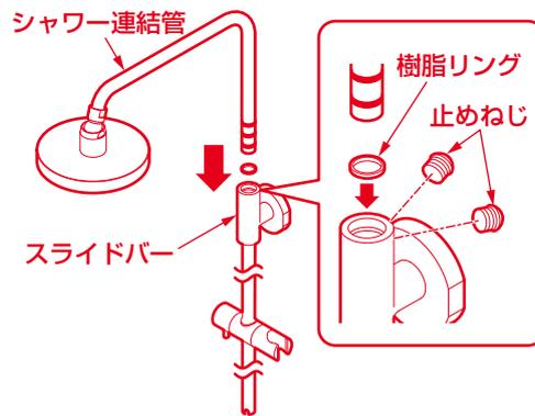
※樹脂リング→シャワー連結管→止めねじの順で取り付ける。
