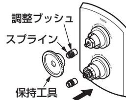
3. 保持工具が回らないように手で押さえて、六角穴付きボルトで強く締め付けて固定する。
