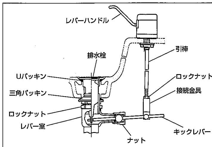
●ナットは、三角パッキンの弾性を失わない程度に締付けてください。強く締めすぎると、陶器を破損することがあります。
