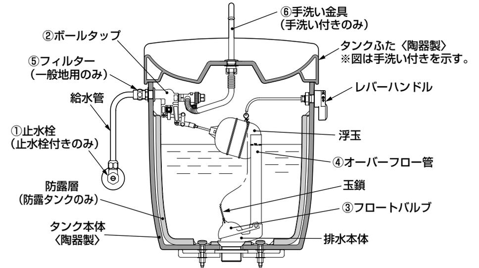
※防露タンクは、陶器製のタンク内の内側に樹脂製の防露層を張り付けた構造になっています。したがって、防露層は陶器と違って耐久性に限度がありますので、修理や交換が必要となる場合があります。
