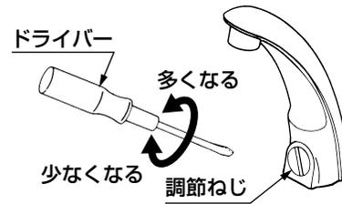
**ドライバーなどで調節ねじを回して、適量な吐水量に調節する。**
