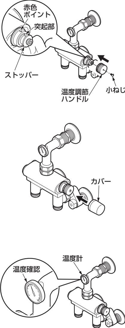
5. ストッパーの突起部が赤色ポイントに合うように取り付ける。さらに温度調節ハンドルをはめ小ねじで固定する。
