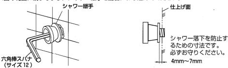
2.シャワーヘッドを止めねじでシャワー継手に取付けてください。
