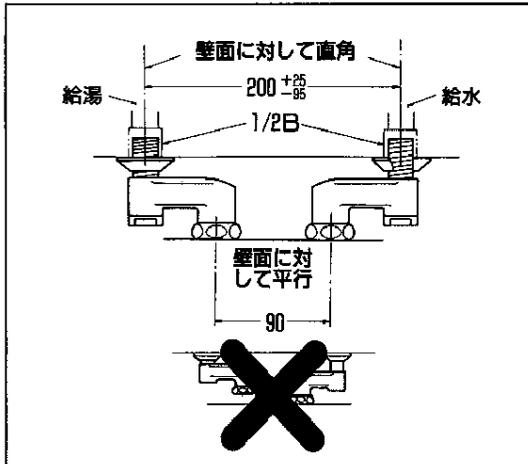
止水栓の取付位置が本体よりも上になると寒冷地用の場合は水抜きができませんので必ず下図のように取付けてください。
