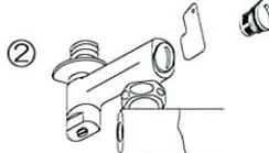
付属の開閉工具でフィルターをゆるめて取出してください。
