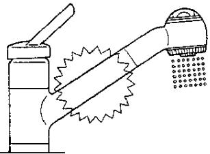
混合栓の本体は高温になるため金具の表面に直接ふれないでください。また高温で吐水させた後はしばらく水を出し、残湯を流しておいてください。
