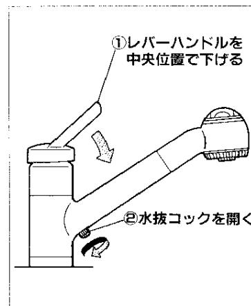
凍結のおそれがある場合は水抜栓の操作と合わせて左図の番号順に操作し器具内の水抜きをしてください。水抜きを行っていても吐水口キャップの網目に付着した水滴が凍り通水しにくいことがあります。この場合はぬるま湯で暖めてください。
