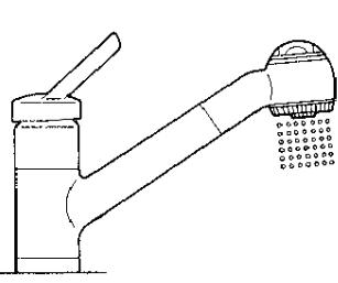
湯を使用した後、次に使用するとき若干温度変化する場合がありますので、しばらく吐水させて湯温が安定してからご使用ください。
