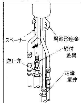
(2)逆止弁を止水栓に仮固定した後、給水・給湯パイプの必要長さをあたり切断してください。このとき、パイプの差込代は約25mm確保してください。
