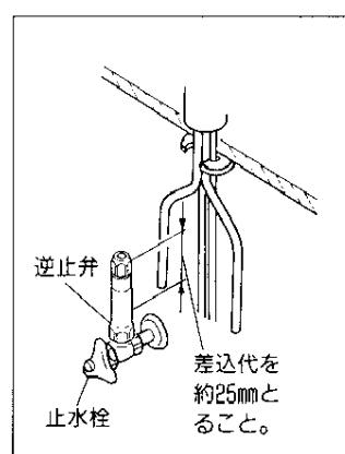
(3)水栓本体は、下部リングの止めネジが真後ろになるように、IN側パイプに、馬蹄形座金、スペーサーと差し込み、ナットで締め付け、固定します。
