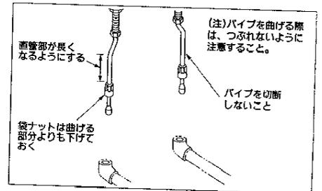
**注意** この製品は、施工誤差を吸収するために給水・給湯パイプを切断することはできません。配管の際は寸法図をご覧のうえ、十分注意して配管してください。
