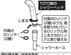
取り替え後、必ず水を出して確認してください。 水が漏れるまたは、ロリングがはみ出ている場合は、 もう一方のロリングに取り 替えてください。
